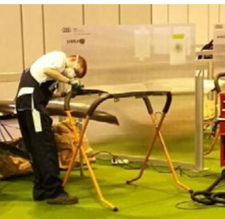
Support pour des pièces en réparation ou pour des pièces à peindre avec des rouleaux, pour éviter d'abimer les pièces.
